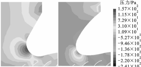
图 10 蜗舌区域压力云图
